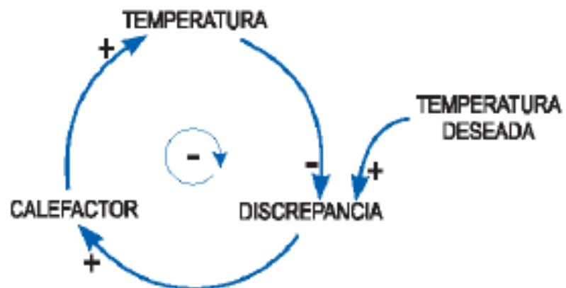
Estructura de retroalimentación balanceada para regular temperatura
